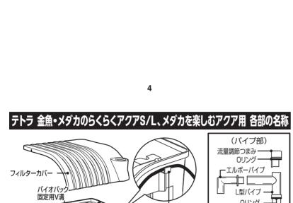
ロリング コード固定フック (モーター部) L型パイプ ロリング ストレーナ インペラ フィルター (ストレーナー部取付用) ケースカバー 下部カバー バイオバック ジュニア ストレーフ (ろ過材) ・垂直調節レバー フィルタ ※品質向上のため、各種パーツは予告なく変更されることがありますので、予めご了承ください ●金魚鉢などの枠が直線でない水槽には使用できません。 ●水槽の内寸高さが14cm未満の水槽には装着できません。 ●水槽の枠(フレーム)の幅が1.2cmを超える水槽には装着できません。 (ご注意)
