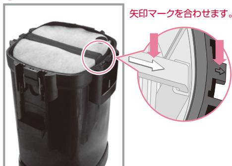
ろ材コンテナをフィルターケースにセットする時、ろ材コンテナの取っ手部分に記載されている「→(矢印)」マークをフィルターケースに記載されている「→(矢印)」部に合わせます。ろ材コンテナは接続パイプ部に合わせ、ひとつのパイプとして通じるようにセットします。
