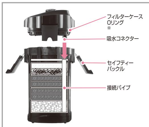
モーターヘッドに装着されているフィルターケース Oリングが汚れていたり異物が付着していないかを確認します。モーターヘッドをフィルターケースに載せます。この時モーターヘッドの吸水コネクタが、ろ材コンテナの接続パイプ部と合うようにします。
