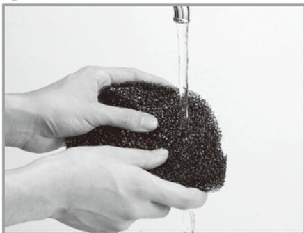
ろ材をろ材コンテナよりすべて取り出し、水道水などですべてのろ材を軽くすすぎ洗います。(ビニール袋入りのバイオガラスリングと活性炭はビニール袋より取り出してご利用ください。)洗浄が終わりましたら再びろ材コンテナ内に同じ順番でセットします。(セット順番はP.4参照)
