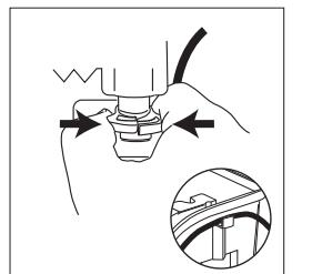
9 インペラーカバーを逆手順で戻したら、モーター固定ラバーを取り付け、図のようにクリップでしっかりと固定し、フィルターケースに差し込みます。モーターのコードは必ずコード固定フックにたるまないように掛けしてください。
