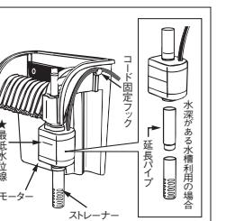
6 モーターにストレーナーを接続します。ストレーナーは水槽の砂利などに埋まらないようにしてください。砂を吸い込みますと停止し、故障の原因となることがあります。延長パイプが付属されていますので、水深がある水槽の場合モーターへ延長パイプを接続し利用することもできます。
