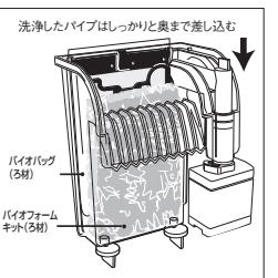
5 新しいバイオバッグ、及び飼育水をカカルキを中和した水で洗浄したバイオフォームキットを図のようにしっかりとセットして、水槽枠に取り付けます。
