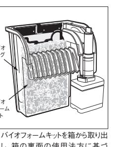
5 バイオフォームキットを箱から取り出し、箱の裏面の使用法方にに基づき、図のようにバイオバッグの手前に対し込みます。
