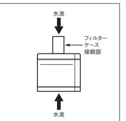
8 モーター内部の内水路を強い水流で洗浄し、ゴミを取り除きます。(フィルターケース接続部に水道からホースなどをつなげ、水道の水圧で逆方向から強い水流でゴミを洗い流します。)
