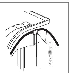
7 モーターの落下防止のため、モーターから出ているコードは必ずフィルターケース本体のコード固定フックに確実に掛けでご使用ください。
