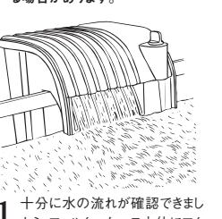
11 十分に水の流れが確認できましたら、フィルターケース本体にフタをしてセット完了です。
