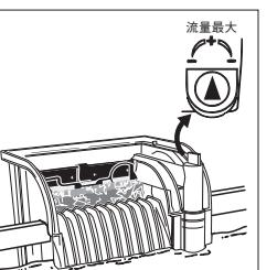
9 フィルターケースが水槽の外側になるように水槽枠にセットし、水槽の水面位置が、モーターの最低水位線より必ず上になるように調節してください。流量調節つまみを+（プラス）側に回し、流量が最大になるように調節します。
