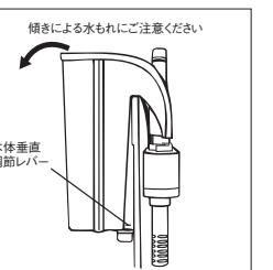
8 調節レバーを取り付けて本体垂直調節レバーを回し、フィルターケース位置を垂直に近づけてください。
