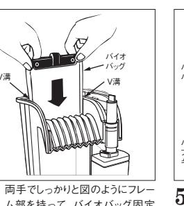
4 両手でしっかりと図のようにフレーム部を持って、バイオバッグ固定用V溝にバイオバッグの両端を入れ、底部に届くまでしっかりとセットします。
