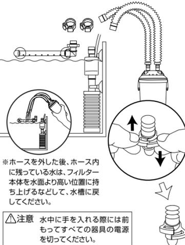
モーター部のプラグをコンセントから抜き、電源を切ります。モーター部、シャワーパイプ部に接続しているホースのホースクリップを外してから、ホースを外します。
