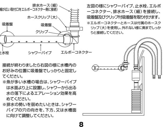
左図の様にシャワーパイプ、止水栓、エルボーコネクター、排水ホース(細)を接続し、吸着盤及びクリップ付吸着盤を取り付けます。
