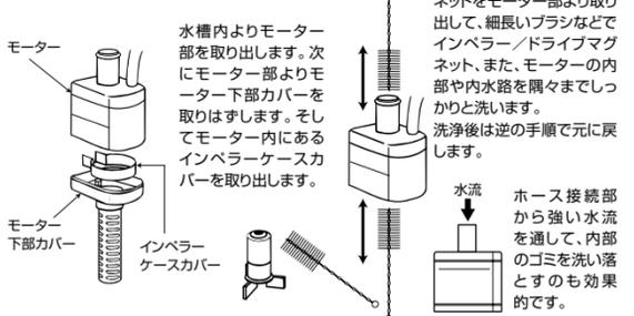
水槽内よりモーター部を取り出します。次にモーター部よりモーター下部カバーを取り出します。そしてモーター内にあるインペラーケースカバーを取り出します。
