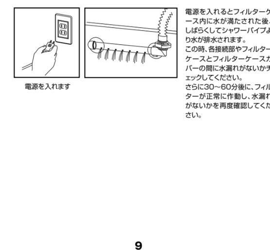
電源を入れるとフィルターケース内に水が満たされた後、しばらくしてシャワーパイプより水が排水されます。この時、各接続部やフィルターケースとフィルターケースカバーの間に水漏れがないかチェックしてください。
