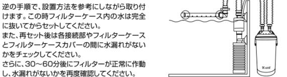
逆の手順で、設置方法を参考にしながら取り付けます。この時フィルターケース内の水は完全に抜いてからセットしてください。また、再セット後は各接続部やフィルターケースとフィルターケースカバーの間に水漏れがないかをチェックしてください。さらに、30～60分後にフィルターが正常に作動し、水漏れがないかを再度確認してください。
