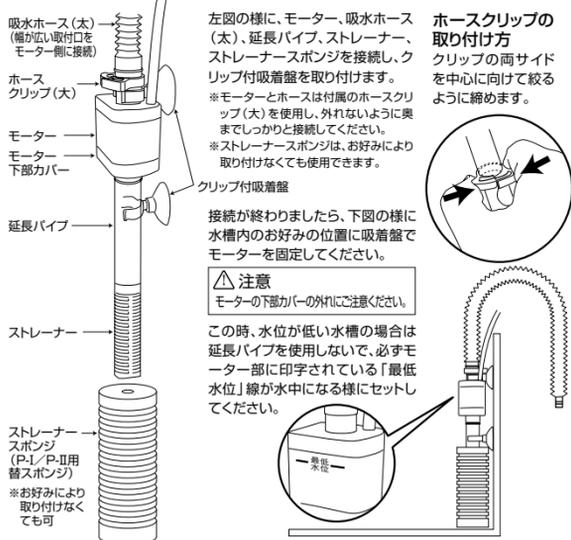
左図の様に、モーター、吸水ホース(太)、延長パイプ、ストレーナー、ストレーナー吸着盤を取り付けます。
