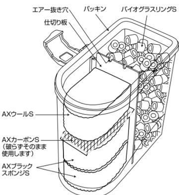
各種素材を取り出し、フィルターケース内部と各種素材、パッキンを軽く流水ですすいでから左図のようにセットしてください。
