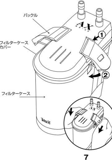
1. フィルターケースにパッキンが確実に装着されていることを確認してから、フィルターケースカバーをフィルターケースにしっかりと押し込みます。
