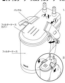
1、フィルターケースにパッキ ンが確実に装着されてい ることを確認してから、フ ィルターケースカバーをフ ィルターケースにしっかり 押し込みます。
