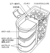
各種ろ材を取り出し、フィルタ ーケース内部と各種ろ材、パ ッキンを軽く流水ですすいで から左図のようにセットしてく ださい。
